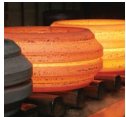
Aros perfilados en la bancada de enfriamiento
