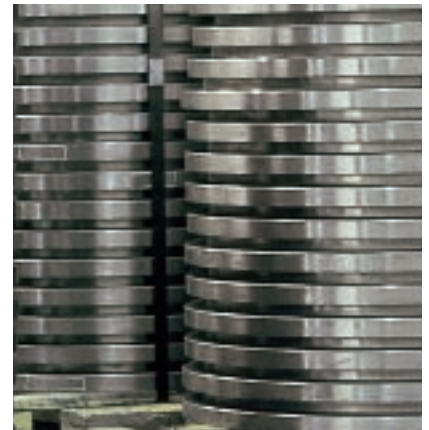
Aro de titanio laminado con perfil para mecanismos propulsores aeronáuticos
